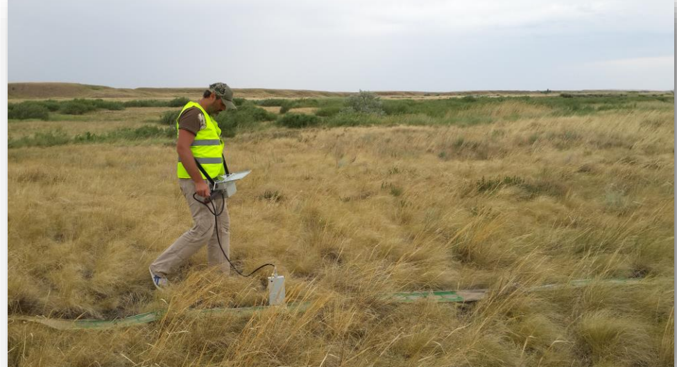
Георадарное профилирование тыловых откосов плотины
